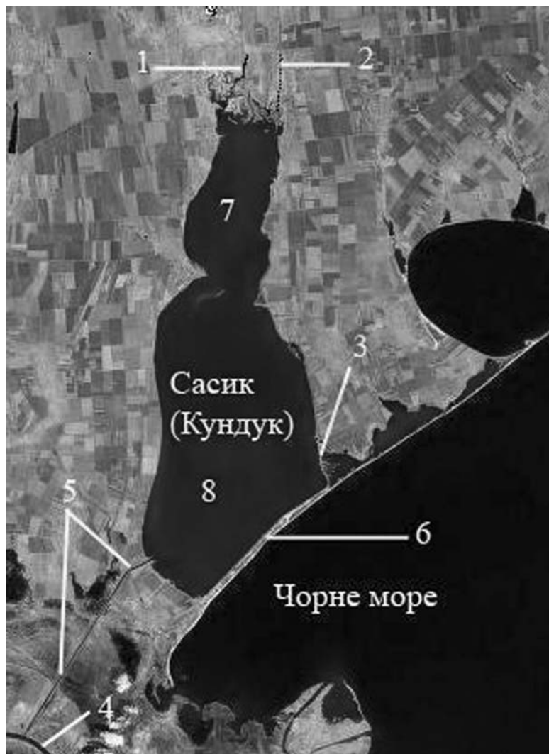
Рис. 1. Водойма Сасик (спутниковий знімок 22 червня 2005 р.): 1 – р. Когильник; 2 – р. Сарата; 3 – шлюз-водоскид; 4 – Соломонів рукав р. Дунай; 5 – канал Дунай–Сасик; 6 – дамба між Сасиком та морем; 7 – північна частина Сасика; 8 – південна частина Сасика.
